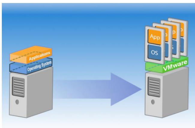
ภาพที่ 2.1 แสดงแนวความคิดในการทำเซิร์ฟเวอร์เวอชวลไลเซชัน
