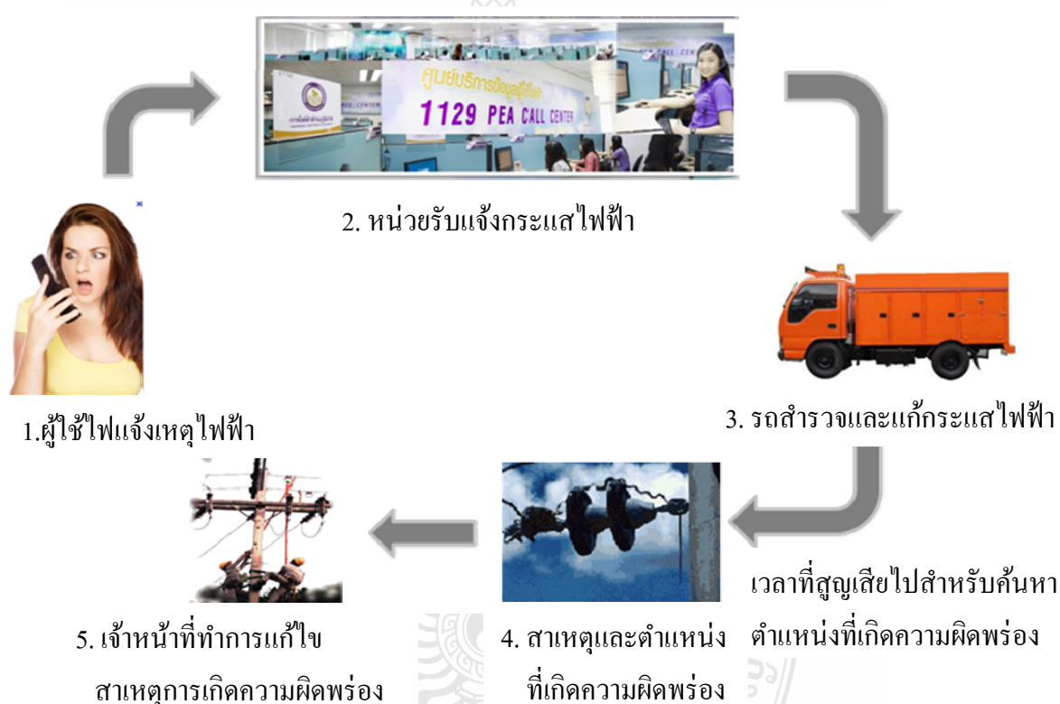
ภาพที่ 1.2 ขั้นตอนการแก้กระแสไฟฟ้าขัดข้องของการไฟฟ้าส่วนภูมิภาค
