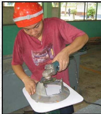
(2) งานเจียรตบแต่งหลังการปรับปรุง
