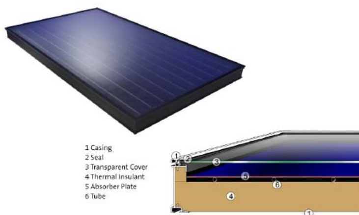
ภาพที่ 2.5 ส่วนประกอบของแผงรับแสงอาทิตย์ชนิดแผ่นเรียบ [1]
