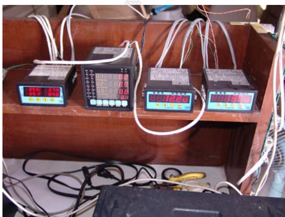
ภาพที่ 4.40 เครื่องมือวัดที่เป็นอุปกรณ์ slave
