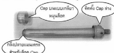
รูปที่ 10 Cap บน ใช้เป็นแบบเกลียวหมุนล๊อค Cap ล่างใช้ Cap อลูมิเนียม
