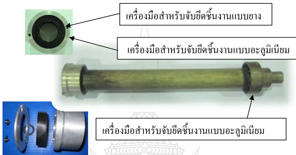
ภาพที่ 4.15 เครื่องมือสำหรับจับยึดชิ้นงานอะลูมิเนียมรวมกับยาง
