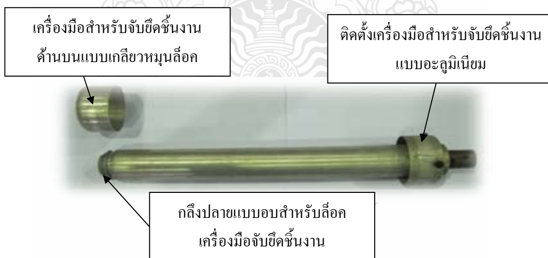
ภาพที่ 4.9 เครื่องมือสำหรับจับยึดชิ้นงานด้านบน ใช้เป็นแบบเกลียวหมุนล็อก ด้านล่างใช้แบบอะลูมิเนียม
