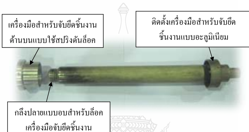
ภาพที่ 4.12 เครื่องมือสำหรับจับยึดชิ้นงานด้านบนแบบใช้สปริงคั่นล็อกด้านล่างใช้แบบอะลูมิเนียม
