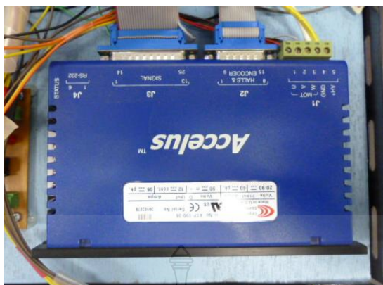
ภาพที่ 3.3 มอเตอร์ไดรฟ์ Accelus รุ่น ASP-090-36
