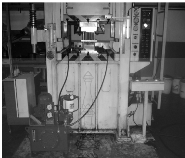
ภาพที่ 3.30 แม่พิมพ์พร้อมใช้งานติดตั้งบนเครื่องเพรสไฮดรอลิก
