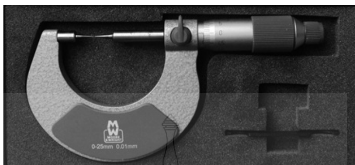
ภาพที่ 3.11 ไมโครคาลิปเปอร์สำหรับวัดความหนาชั้นงาน
