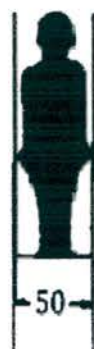
ภาพที่ 2.14 ช่องว่างระหว่างผนังกำแพงที่คนเดินผ่านได้
