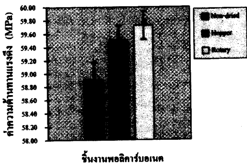
รูปที่ 6 เปรียบเทียบค่าความต้านทานแรงดึงของผลิตภัณฑ์ที่ขึ้นรูปจากเม็ดพลาสติก PC ที่อบแห้งในสถานะต่างๆ และที่ไม่อบแห้ง
