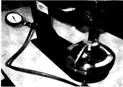
รูปที่ 4 เครื่องทดสอบการรั่วซึมบริเวณแนวตะเข็บ
