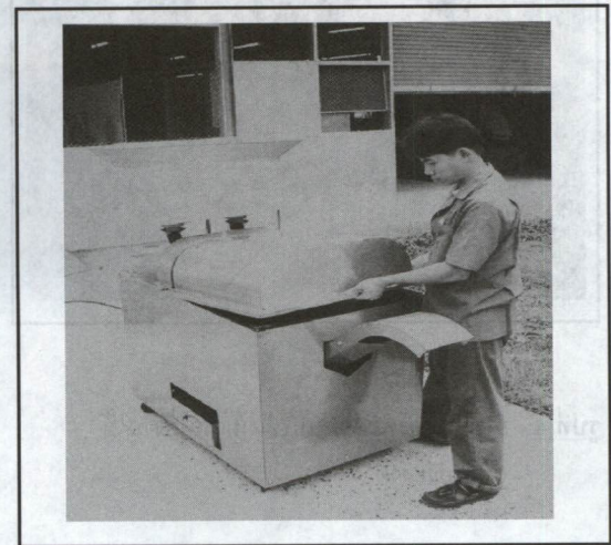
รูปที่ 2 ฝาครอบสามารถเปิดออกเพื่อทำการปรับหน้า งานกะเทาะและเพื่อการซ่อมบำรุง
