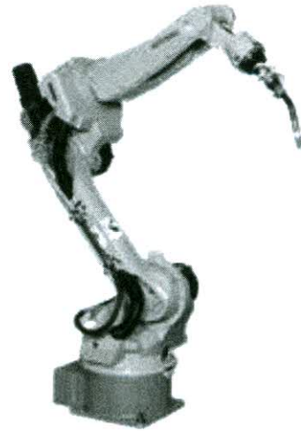
รูปที่ 4 แขนกลในการเชื่อมคานกันกระแทกจับหัวเชื่อม 1 หัว ก่อนปรับปรุง
