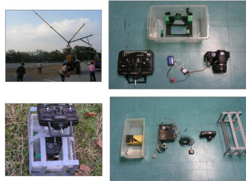
รูปที่ 2 การออกแบบสร้างระบบถ่ายภาพมุมสูงควบคุมระยะไกลแบบ พ่วงติดท้ายรถแทรกเตอร์ (ก): แสดงการติดตั้งระบบและชุด ถ่ายภาพควบคุมระยะไกล และ (ข): แสดงส่วนประกอบของ ระบบถ่ายภาพระยะไกล
