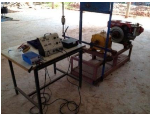
รูปที่ 2 ชุดทดสอบเครื่องยนต์ดีเซลสูบเดี่ยวทางการเกษตร
