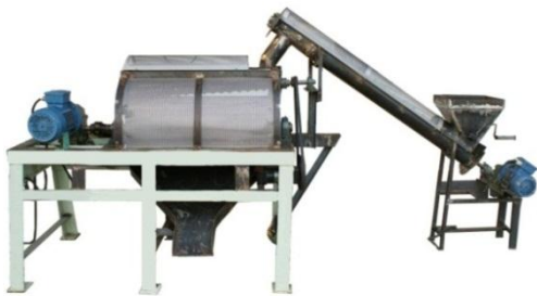
รูปที่ 1 เครื่องกะเทาะเมล็ดมะคาเดเมียระดับอุตสาหกรรม
