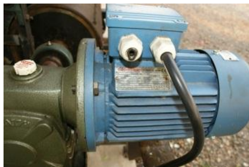
รูปที่ 4 มอเตอร์ต้นกำลัง ขนาด 2 แรงม้า 1,400 รอบต่อนาที ผ่าน ชุดทดรอบ 1:10
