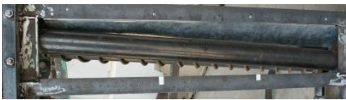
รูปที่ 7 เครื่องคัตขนาดติดตั้งบนเครื่องกะเทาะเมล็ดมะคาเดเมีย
