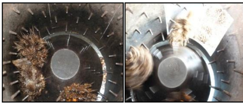
รูปที่ 3 ลักษณะภายในถังแยกของเครื่องขณะทำการผลิตผลออกจากทะเลาะปาล์มน้ำมัน
