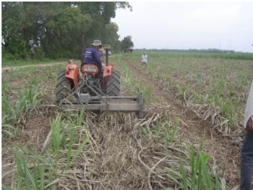
รูปที่ 6 แสดงการใช้แทรกเตอร์ขนาด 34 แรงม้าพ่วงเครื่องสับใบอ้อย และใบอ้อยเข้ามาพันแกนลูกตี
