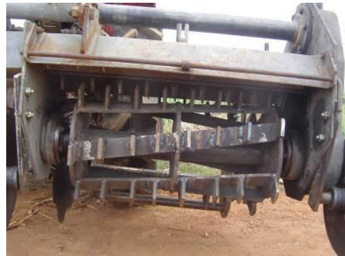
รูปที่ 7 แสดงให้เห็นการขยายขนาดลูกตีให้ใหญ่ขึ้น
