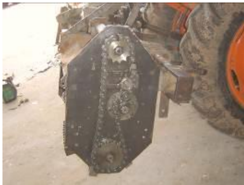
รูปที่ 16 ลูกดีทั้งสอง หมุนสวนทาง
