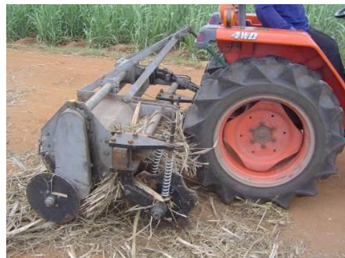
รูปที่ 8 แสดงให้เห็นว่าใบอ้อยมีการอุดตัน
