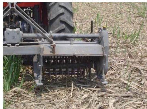
รูปที่ 5 ชุดลูกตีมีลักษณะเป็นเหล็กพืดแบน
