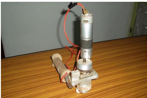
รูปที่ 1 มีดกรีดยางพาราแบบใช้มอเตอร์ไฟฟ้า
