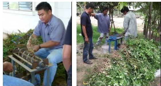
รูปที่ 5 การปลิดฝักถั่วลิสงด้วยเครื่องต้นแบบ
