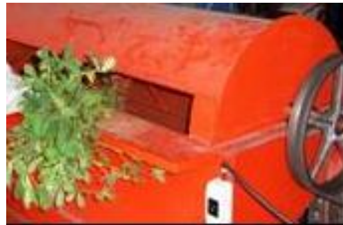
ง. ใช้ต้นกำลังขับหมุนกรงกระรอกราวเหล็ก
