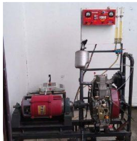
รูปที่ 2 การติดตั้งเครื่องยนต์ใช้ทดสอบกับแท่นทดสอบและเครื่องมือวัด
