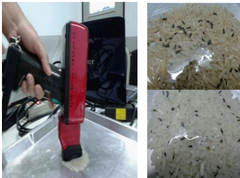
รูปที่ 2 การวิธีการติดตั้งฟิล์ม และการวัดค่าโดยใช้เครื่อง FQA NIR GUN
