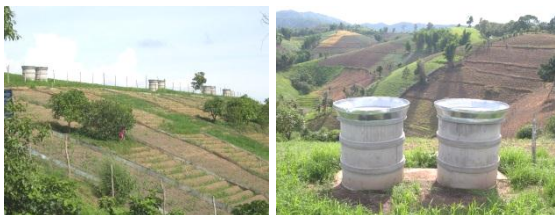
รูปที่ 1 ถังเก็บน้ำฝนและการติดตั้งบนแปลงทดลอง
