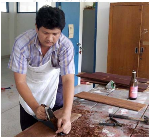
ภาพที่ 47 ผู้วิจัยกำลังใส่ไม้เก่าด้วยกบเหล็ก
