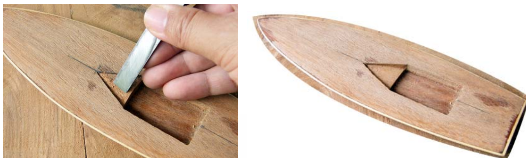
ภาพที่ 60 ตัวเรือที่ปรับแต่งช่องที่นั่ง
