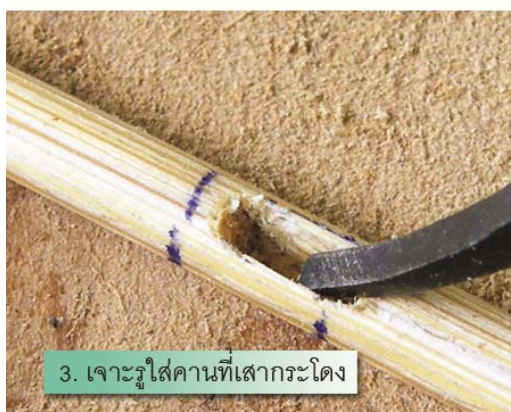
ภาพที่ 63 ขั้นตอนเจาะใส่เสากระโดงเรือ
