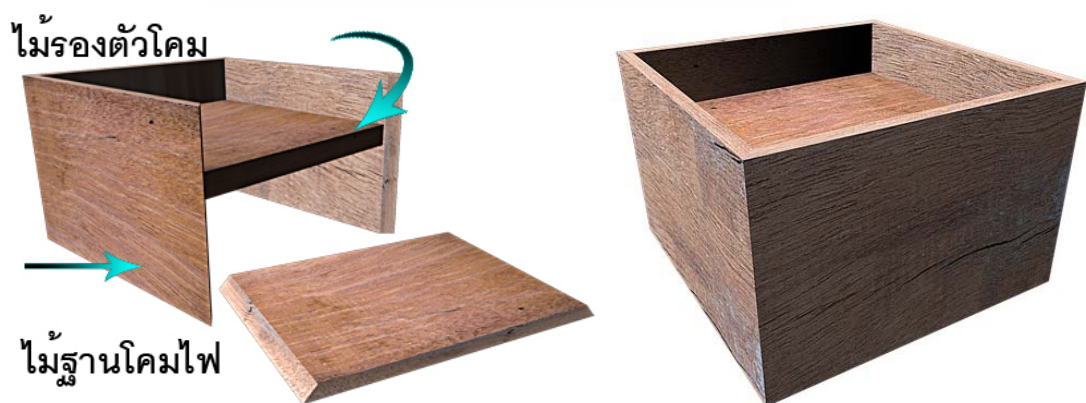
ภาพที่ 42 ฐานโคมไฟ
