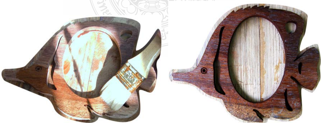
ภาพที่ 36 การทาแชลแล็คเพื่อรองพื้นก่อนทำสี
