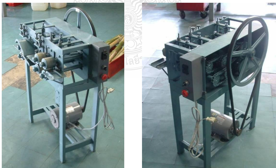
รูปที่ 3.3 เครื่องจักรตอกไม้ไผ่ที่สร้างขึ้นตามการออกแบบ
