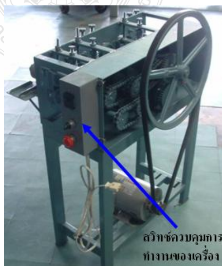
รูปที่ 3.8 แสดงสวิตช์ควบคุมการทำงานของเครื่อง
