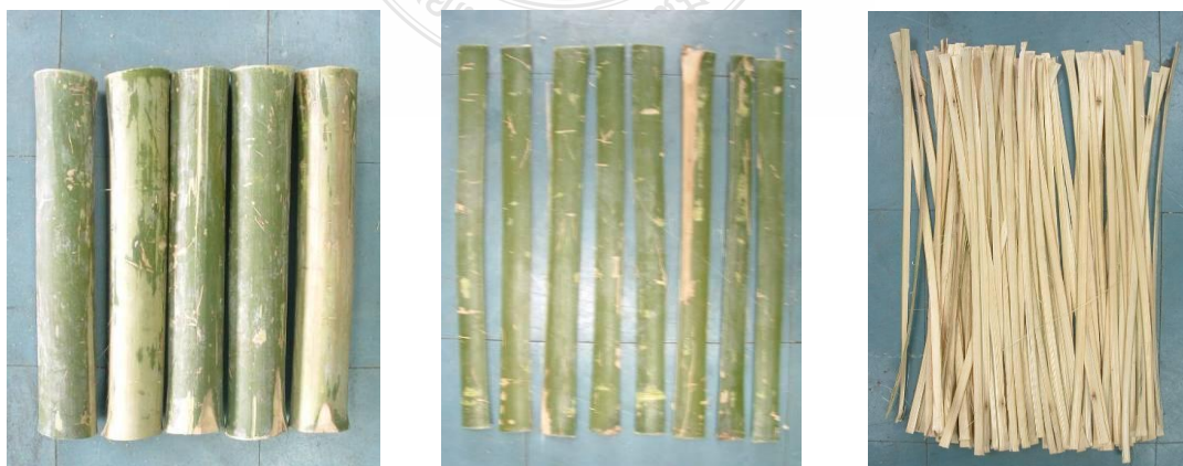
รูปที่ 4.1 แสดงผลการทดลองจักรตอกจากไม้ไผ่หนึ่งปล้อง
