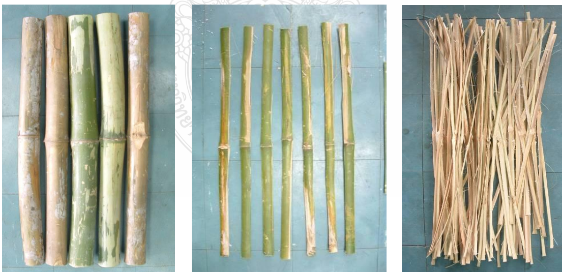
รูปที่ 4.4 แสดงผลการทดลองจักตอกจากไม้ไผ่สองปล้อง
