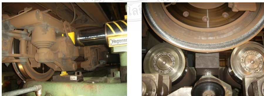
รูปที่ 3.16 ชุดอุปกรณ์ในการควบคุมเครื่องกลึงล้อ
