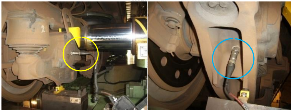
รูปที่ 3.20 การติดตั้งหัววัดในแนวแกนและแนวรัศมี (Axial, Radial)
