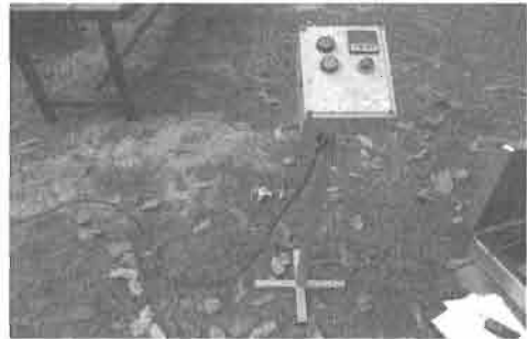
รูปที่ 6 เครื่องวัดอุณหภูมิ และความชื้นสัมพัทธ์ Testo625
