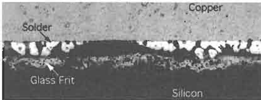
รูปที่ 10 เชื่อมต่อของเซลล์ (Silicon) กับลวดนำไฟฟ้า (Copper)
