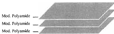
รูปที่ 8 แผ่นปิดด้านหลังโครงสร้างเป็นโมดิไฟด์พอลิเอไมด์
