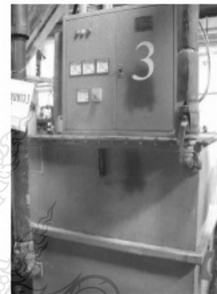
รูปที่ 2 หม้อแปลงชุบขาวที่ใช้ในการชุบอลูมิเนียม
