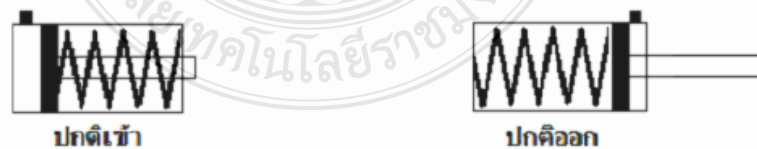
ภาพที่ 2-19 แสดงสัญลักษณ์ของกระบอกสูบทางเดียวแบบปกติเข้าและปกติออก
