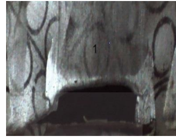
รูปที่ 3.27 กริดวงกลมซึ่งทำการวัดในบริเวณที่เกิดการร้าวบนผิวชิ้นงาน
