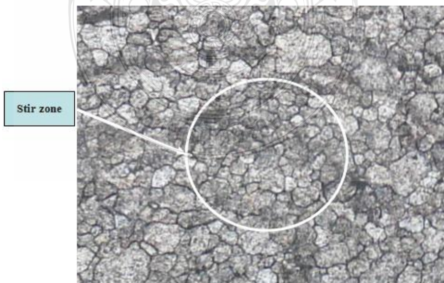
รูปที่ 4.16 พื้นที่ของเนื้ออลูมิเนียมที่เกิดการกวนของเครื่องมือเชื่อมในบริเวณ (ค) [24]
