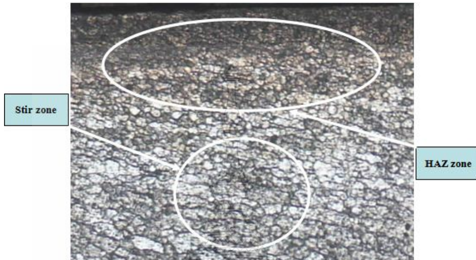
รูปที่ 4.17 ขอบเขตระหว่างพื้นที่ที่ได้รับอิทธิพลความร้อนจากการเชื่อมและพื้นที่ของเนื้ออลูมิเนียมที่เกิดการกวนของเครื่องมือเชื่อมในบริเวณ (ง) [24]
