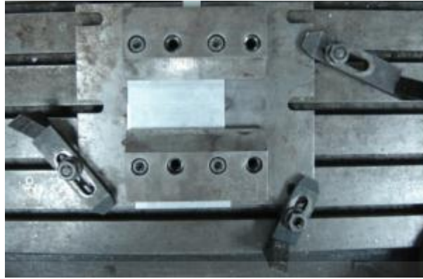
รูปที่ 3.7 อุปกรณ์ช่วยจับยึดชิ้นงานและแผ่นรองชิ้นงาน
