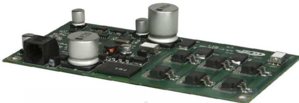
ภาพที่ 2.19 มอเตอร์ไครว์ Accelus รุ่น ASP – 090 – 09 [11]
