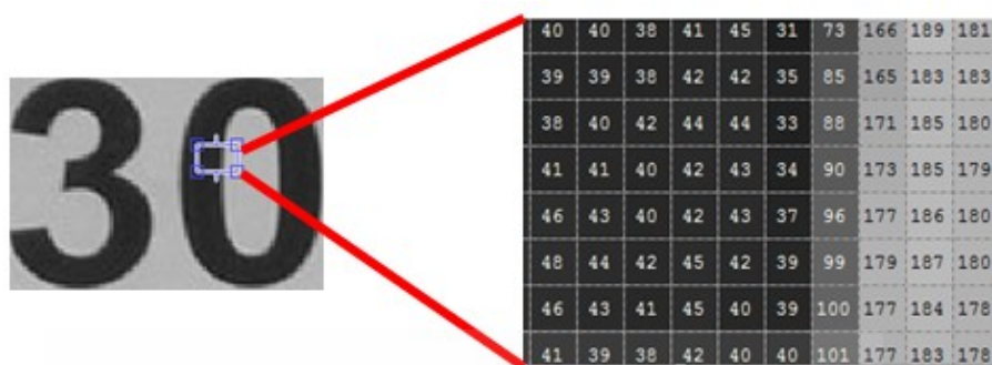
ภาพที่ 3.21 ตัวอย่างภาพระดับสีเทาของตัวเลขบนป้ายจำกัดความเร็ว
