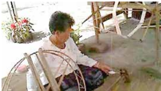
ภาพที่ 8 การกรอเส้นด้ายพุ่งเข้าหลอด
