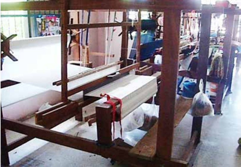
ภาพที่ 11 ลักษณะเครื่องทอผ้า พร้อมทอผ้าเส้นใยฝักตบชวาผสมเส้นด้ายฝ้าย
