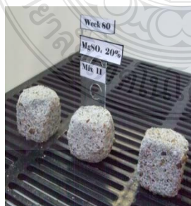
ภาพที่ 4.94 ภาพถ่ายของตัวอย่างมอร์ต้ารูปปูนซีเมนต์ปอร์ตแลนด์ล้วน ปูนซีเมนต์ปอร์ตแลนด์ประเภทที่ 1 และปูนซีเมนต์ปอร์ตแลนด์ประเภทที่ 5 ผสมเกลือและผงหินปูนที่อายุของการแช่ 80 สัปดาห์ ในสารละลายแมกนีเซียมซัลเฟต (ต่อ)
