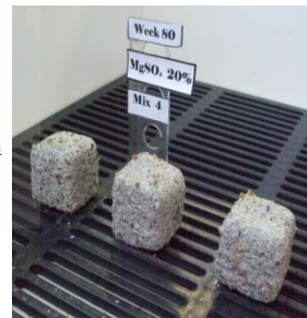
ภาพที่ 4.94 ภาพถ่ายของตัวอย่างมอร์ต้าร์ปูนซีเมนต์ปอร์ตแลนด์ล้วน ปูนซีเมนต์ปอร์ตแลนด์ประเภทที่ 1 และปูนซีเมนต์ปอร์ตแลนด์ประเภทที่ 5 ผสมเถ้าลอยและผงหินปูนที่อายุของการแช่ 80 สัปดาห์ ในสารละลายแมกนีเซียมซัลเฟต (ต่อ)
