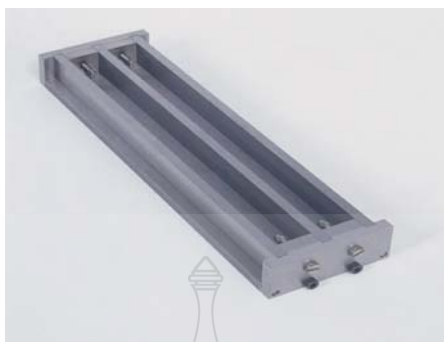
ภาพที่ 3.5 แบบหล่อตัวอย่างขนาด 25×25×285 มม.
