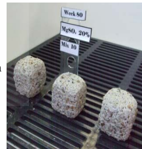
ภาพที่ 4.94 ภาพถ่ายของตัวอย่างมอร์ต้ารูปปูนซีเมนต์ปอร์ตแลนด์ล้วน ปูนซีเมนต์ปอร์ตแลนด์ประเภทที่ 1 และปูนซีเมนต์ปอร์ตแลนด์ประเภทที่ 5 ผสมเกลือและผงหินปูนที่อายุของการแช่ 80 สัปดาห์ ในสารละลายแมกนีเซียมซัลเฟต (ต่อ)
