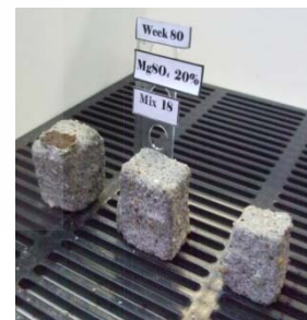
ภาพที่ 4.94 ภาพถ่ายของตัวอย่างมอร์ต้าร์ปูนซีเมนต์ปอร์ตแลนด์ล้วน ปูนซีเมนต์ปอร์ตแลนด์ประเภทที่ 1 และปูนซีเมนต์ปอร์ตแลนด์ประเภทที่ 5 ผสมเกลือและผงหินปูนที่อายุของการแช่ 80 สัปดาห์ ในสารละลายแมกนีเซียมซัลเฟต (ต่อ)
