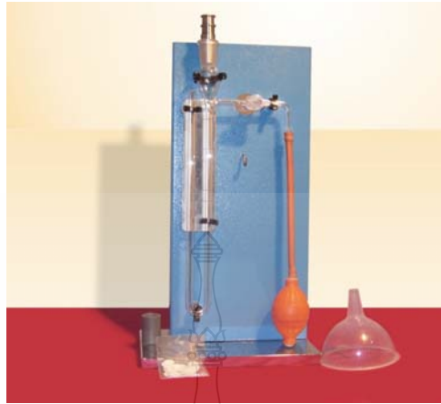
ภาพที่ 3.2 เครื่องมือแอร์เพอร์มิอ์มิอะบิลิตีของเบลนด์ (Air Permeability Apparatus)
