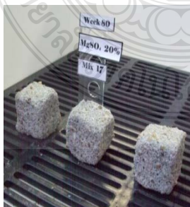
ภาพที่ 4.94 ภาพถ่ายของตัวอย่างมอร์ต้าร์ปูนซีเมนต์ปอร์ตแลนด์ล้วน ปูนซีเมนต์ปอร์ตแลนด์ประเภทที่ 1 และปูนซีเมนต์ปอร์ตแลนด์ประเภทที่ 5 ผสมเกลือและผงหินปูนที่อายุของการแช่ 80 สัปดาห์ ในสารละลายแมกนีเซียมซัลเฟต (ต่อ)
