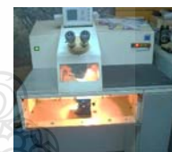
Jewellery laser welding machine (เครื่องเชื่อมเลเซอร์)
