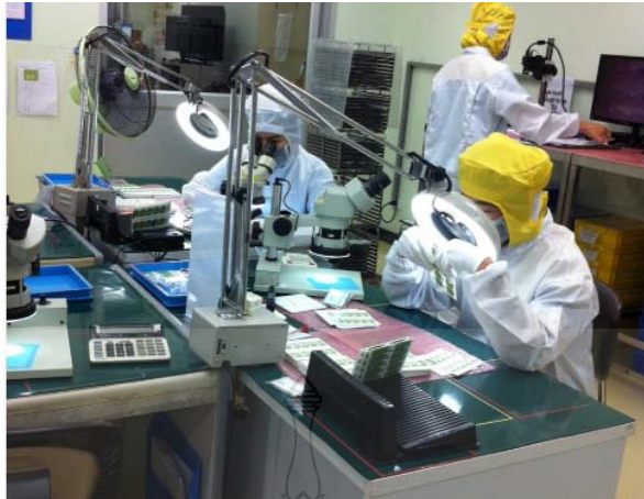
ภาพที่ 3.1 แสดงกระบวนการตรวจสอบแผ่น Substrate Model: NDK ที่ใช้อยู่ในปัจจุบัน
