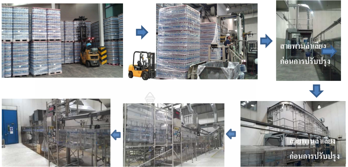
ภาพที่ 4.15 แสดงกระบวนการการลำเลียงขนส่ง-ขนย้ายบรรจุภัณฑ์ขวดน้ำดื่มพลาสติก (ขวดเปล่า) ที่เกิดความสูญเปล่าในกระบวนการผลิตในช่วงก่อนการปรับปรุง
