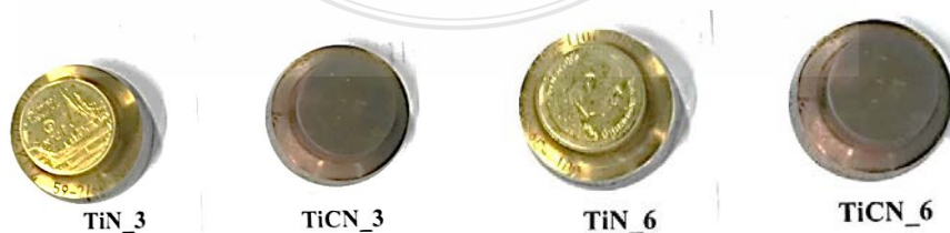
รูปที่ 3.9 แม่พิมพ์ปั๊มเหรียญชนิดราคา 1 บาท (ดวงตราด้านหัวและก้อย)
