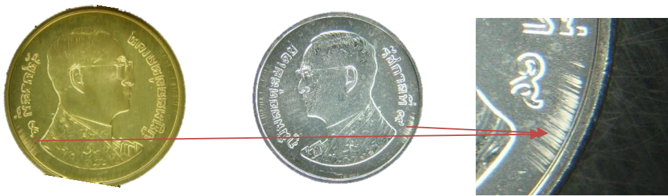
รูปที่ 4.5 ความเสียหายของผิวเคลือบ TiN ขนาดผงขัดเพชร 6 ไมครอน
