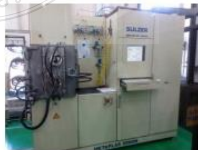
ภาพที่ 4 การชุบเคลือบผิวด้วยวิธีการ PVD
