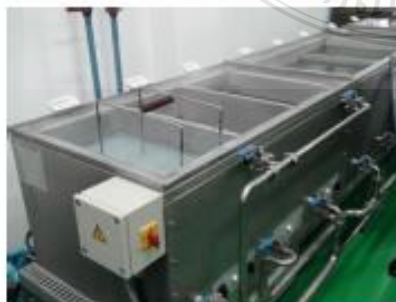
ภาพที่ 3 กระบวนการล้างระบบอุลตราโซนิก
