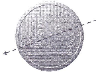
รูปที่ 2.3 แนวการลากผ่านวัดโค้งกระทะ (Curvature) และความสูงลดตายแม่พิมพ์ด้านก้อย
