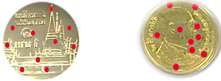
รูปที่ 3.13 ตำแหน่งอ้างอิงการวัดความหนาผิวเคลือบ จำนวน 10 จุด
