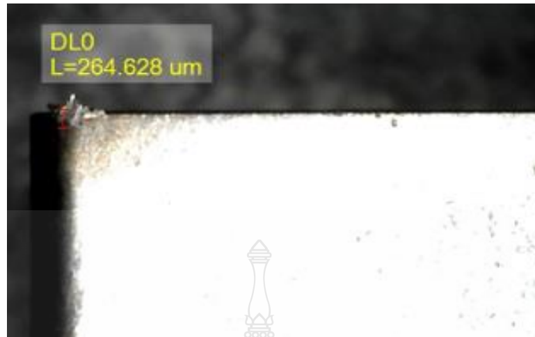
รูปที่ ก.31 การสีกหระของเม็ดมีคดกตั้งจากกรกตั้งที่ระะทาง 1,000 mm แรงคั่นลม 4 Bar ความเร็วตัดที่ 65 m/min อัตราป้อน 0.18 mm/rev ( Test แบบเป่าลม)
