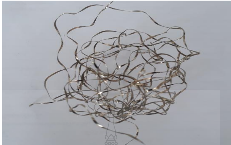
รูปที่ ก.44 เศษคลีปจากการกลึงที่ความเร็วตัด 65 m/min อัตราป้อน 0.13 mm/rev (Dry)
