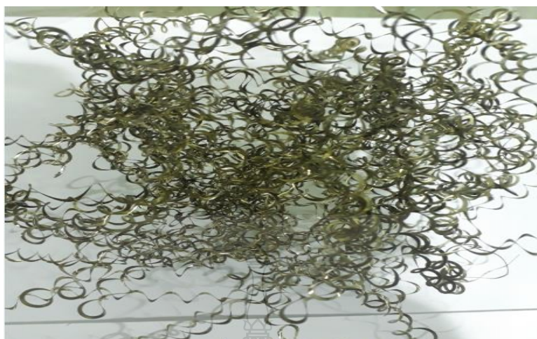
รูปที่ ก.59 เศษคลิปจากการกลึงที่ความเร็วตัด 50 m/min อัตราป้อน 0.085 mm/rev (Wet)
