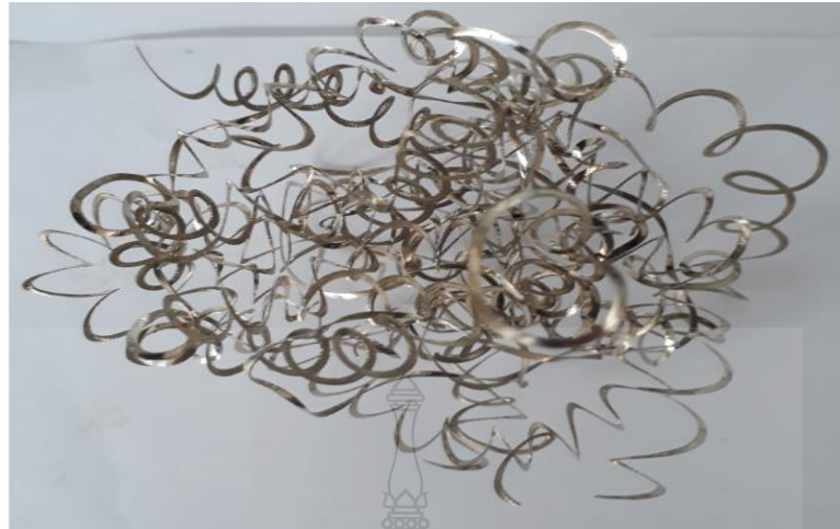
รูปที่ ก.48 เศษคลีปจากการกลึงที่ความเร็วตัด 80 m/min อัตราป้อน 0.18 mm/rev (Dry)
