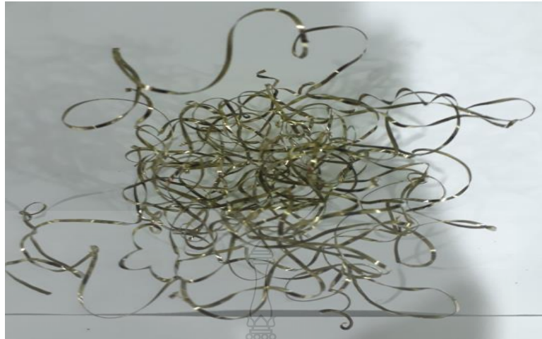
รูปที่ ก.53 เศษคลีปจากการกลึงที่ความเร็วตัด 50 m/min อัตราป้อน 0.13 mm/rev (Air)
