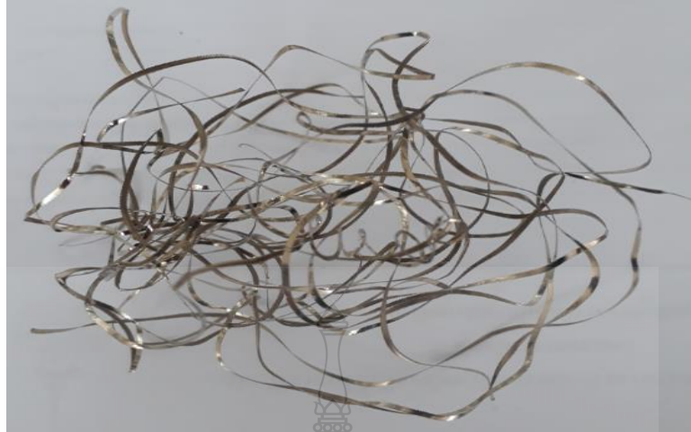
รูปที่ ก.42 เศษคลีปจากการกลึงที่ความเร็วตัด 80 m/min อัตราป้อน 0.085 mm/rev (Dry)
