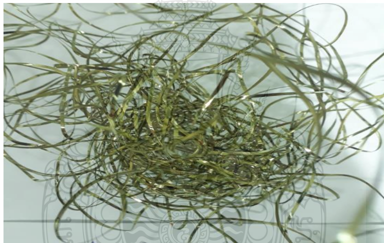
รูปที่ ก.54 เศษคลีปจากการกลึงที่ความเร็วตัด 65 m/min อัตราป้อน 0.13 mm/rev (Air)
