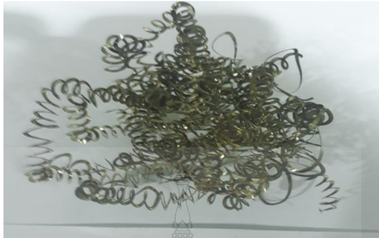
รูปที่ ก.65 เศษคลิปจากการกลึงที่ความเร็วตัด 50 m/min อัตราป้อน 0.18 mm/rev (Wet)
