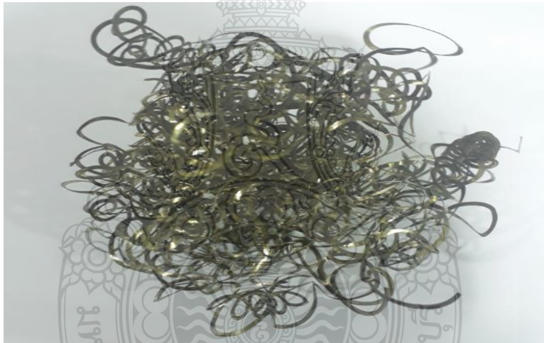
รูปที่ ก.64 เศษคลีปจากการกลึงที่ความเร็วตัด 80 m/min อัตราป้อน 0.13 mm/rev (Wet)
