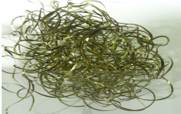
รูปที่ ก.61 เศษคลีปจากการกลึงที่ความเร็วตัด 80 m/min อัตราป้อน 0.085 mm/rev (Wet)
