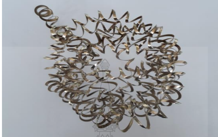
รูปที่ ก.40 เศษคลิปจากการกลึงที่ความเร็วตัด 50 m/min อัตราป้อน 0.085 mm/rev (Dry)
