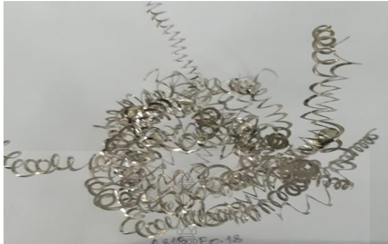
รูปที่ ก.73 เศษคลิป์จากการกลึงที่ความเร็วตัด 65 m/min อัตราป้อน 0.18 mm/rev แรงดันลม 8 Bar (แบบ Test)
