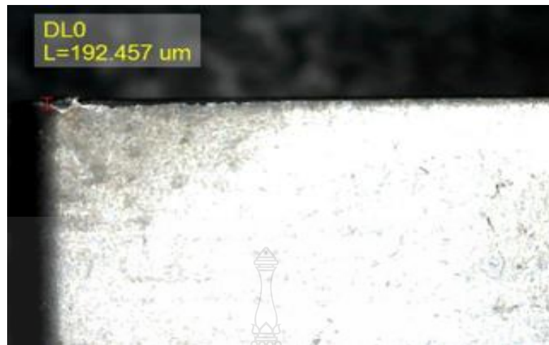
รูปที่ ก5. การสึกหรอของเม็ดมีดกลึงจากการกลึงที่ระยะทาง 1,000 mm ความเร็วตัดที่ 50 m/min อัตราป้อน 0.13 mm/rev แบบเป่า
