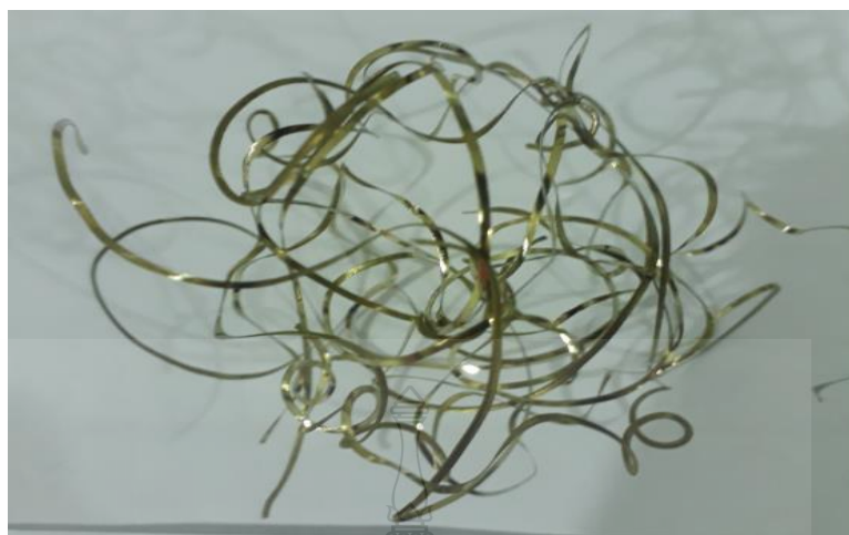
รูปที่ ก.55 เศษคลีปจากการกลึงที่ความเร็วตัด 80 m/min อัตราป้อน 0.13 mm/rev (Air)
