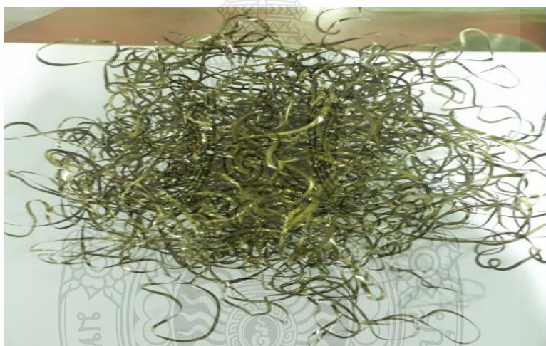
รูปที่ ก.60 เศษคลิปจากการกลึงที่ความเร็วตัด 65 m/min อัตราป้อน 0.085 mm/rev (Wet)
