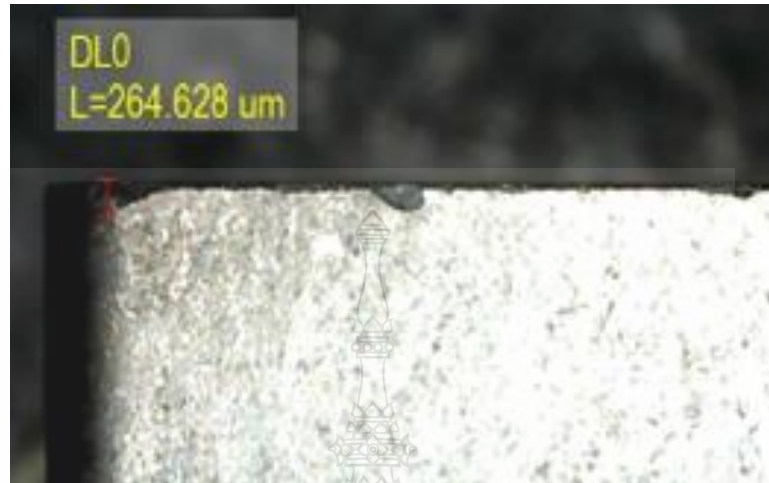
รูปที่ ก1. การสึกหรอของเม็ดมีดกลึงจากการกลึงที่ระยะทาง 1,000 mm ความเร็วตัดที่ 50 m/min อัตราป้อน 0.085 mm/rev แบบแห้ง
