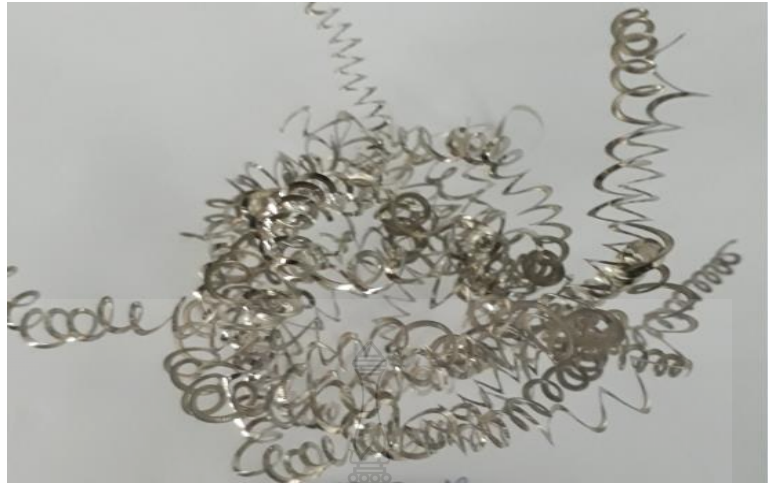
รูปที่ ก.57 เศษคลิปจากการกลึงที่ความเร็วตัด 65 \text{ m/min} อัตราป้อน 0.18 \text{ mm/rev} (Air)
