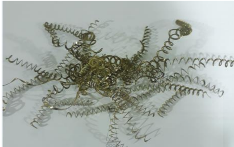
รูปที่ ก.75 เศษคลิปจากการกลึงที่ความเร็วตัด 80 m/min อัตราป้อน 0.18 mm/rev แรงดันลม 6 Bar (แบบ Test)
