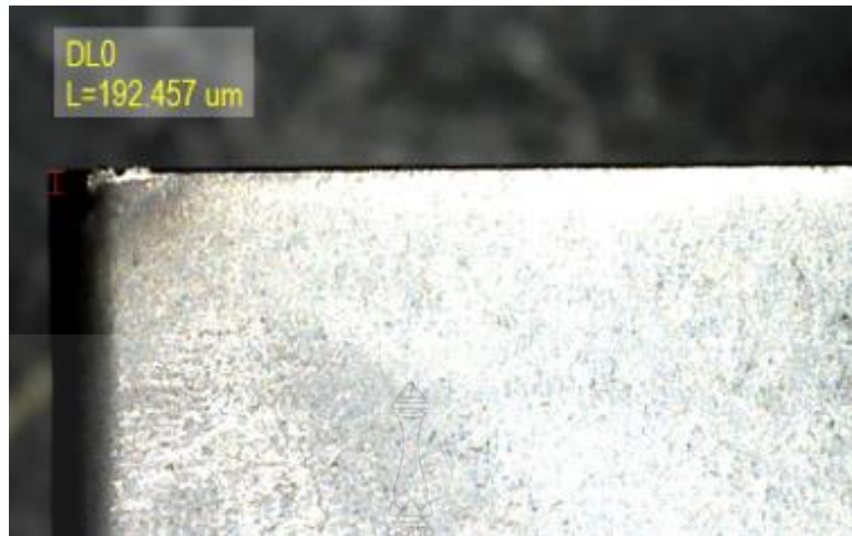
รูปที่ ก19. การสึกหรอของเม็ดมีดกลึงจากการกลึงที่ระยะทาง 1,000 mm ความเร็วตัดที่ 80 m/min อัตราป้อน 0.085 mm/rev แบบแห้ง
