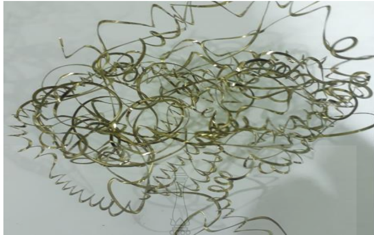
รูปที่ ก.71 เศษคลิปจากการกลึงที่ความเร็วตัด 65 m/min อัตราป้อน 0.18 mm/rev แรงดันลม 4 Bar (แบบ Test)
