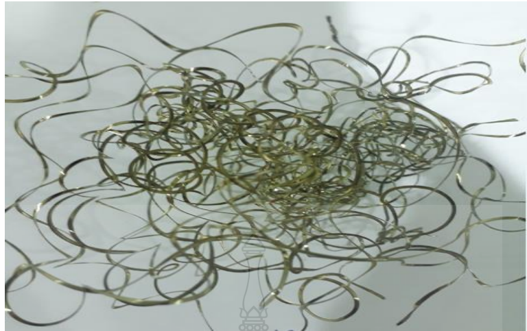
รูปที่ ก.69 เศษคิลิปจากการกลึงที่ความเร็วตัด 50 m/min อัตราป้อน 0.18 mm/rev แรงดันลม 6 Bar (แบบ Test)
