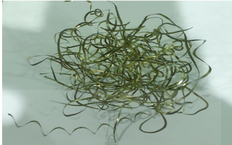
รูปที่ ก.50 เศษคลิปจากการกลึงที่ความเร็วตัด 65 m/min อัตราป้อน 0.085 mm/rev (Air)
