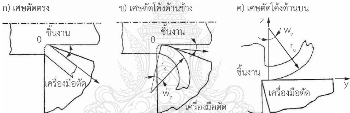
รูปที่ 2.11 ลักษณะต่างๆของการเกิดเศษตัด 3 แบบ [12]
