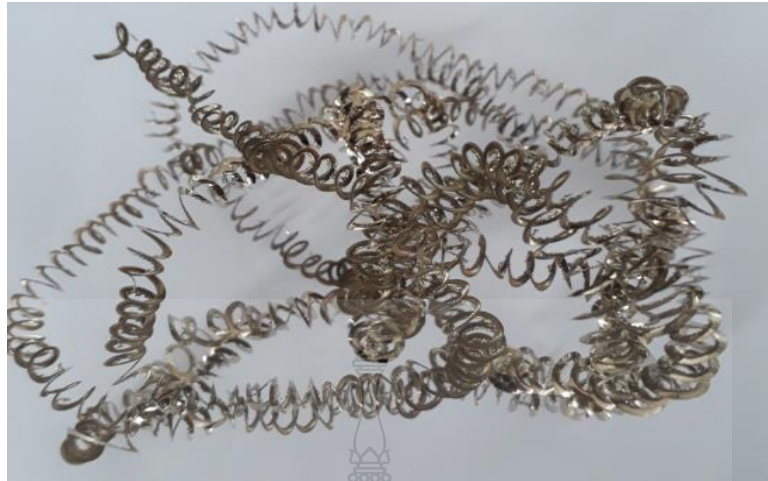
รูปที่ ก.46 เศษคลิปจากการกลึงที่ความเร็วตัด 50 m/min อัตราป้อน 0.18 mm/rev (Dry)
