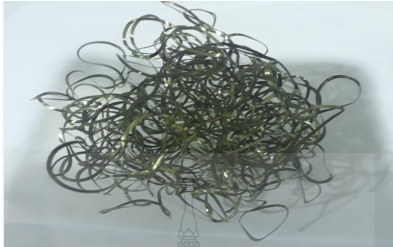
รูปที่ ก.63 เศษคลีปจากการกลึงที่ความเร็วตัด 65 m/min อัตราป้อน 0.13 mm/rev (Wet)
