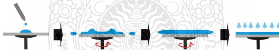
ภาพที่ 2.15 กระบวนการเตรียมฟิล์มบางด้วยวิธีการหมุนเหวี่ยง
