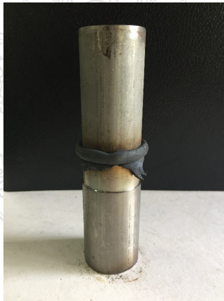
รูปที่ ก.12 ชิ้นงานที่ทำการเชื่อมด้วยแรงเสียดทานด้วยความเร็วรอบ 2,500 รอบ/นาที ความดันที่กดแซ่ 20 บาร์ กดแซ่ 10 วินาที ความดันที่กดอัด 40 บาร์และกดอัดเวลา 7 วินาที
