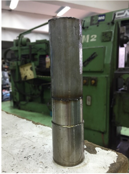
รูปที่ ก.1 ชิ้นงานที่ทำการเชื่อมด้วยแรงเสียดทานด้วยความเร็วรอบ 1,250 รอบ/นาที ความดันที่กด แซ่ 20 บาร์ ความดันที่กดอัด 20 บาร์และกดอัดเวลา 3 วินาที
