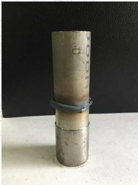
รูปที่ ก.10 ชิ้นงานที่ทำการเชื่อมด้วยแรงเสียดทานด้วยความเร็วรอบ 2,500 รอบ/นาที ความดันที่ กดแช่ 20 บาร์ กดแช่ 10 วินาที ความดันที่กดอัด 20 บาร์และกดอัดเวลา 9 วินาที
