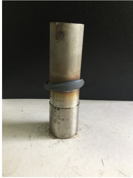
รูปที่ ก.11 ชิ้นงานที่ทำการเชื่อมด้วยแรงเสียดทานด้วยความเร็วรอบ 2,500 รอบ/นาที ความดันที่กดแซ่ 20 บาร์ กดแซ่ 10 วินาที ความดันที่กดอัด 40 บาร์และกดอัดเวลา 5 วินาที
