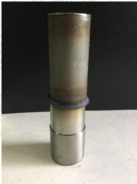
รูปที่ ก.4 ชิ้นงานที่ทำการเชื่อมด้วยแรงเสียดทานด้วยความเร็วรอบ 2,500 รอบ/นาที ความดันที่ก แซ่ 20 บาร์ กดแซ่ 10 วินาที ความดันที่กดอัด 20 บาร์และกดอัดเวลา 5 วินาที
