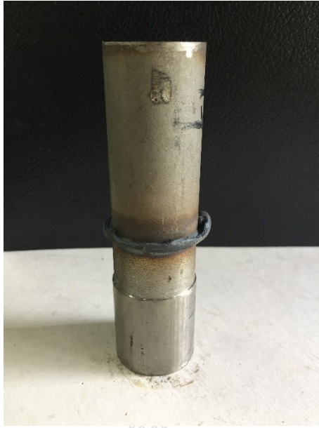
รูปที่ ก.7 ชิ้นงานที่ทำการเชื่อมด้วยแรงเสียดทานด้วยความเร็วรอบ 2,500 รอบ/นาที ความดันที่กด แช่ 20 บาร์ กดแช่ 10 วินาที ความดันที่กดอัด 20 บาร์และกดอัดเวลา 11 วินาที
