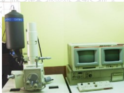
รูปที่ 3.16 กล้องจุลทรรศน์อิเล็กตรอนไมโครสโคป
