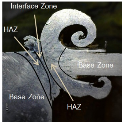
รูปที่ 4.22 โครงสร้างมหภาคชิ้นงานการเชื่อมแรงเสียดทาน ความดันที่ 35 บาร์ เวลาที่ 9 วินาที
