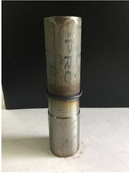
รูปที่ ก.3 ชิ้นงานที่ทำการเชื่อมด้วยแรงเสียดทานด้วยความเร็วรอบ 2,500 รอบ/นาที ความดันที่กด แซ่ 20 บาร์ กดแซ่ 10 วินาที ความดันที่กดอัด 20 บาร์และกดอัดเวลา 3 วินาที
