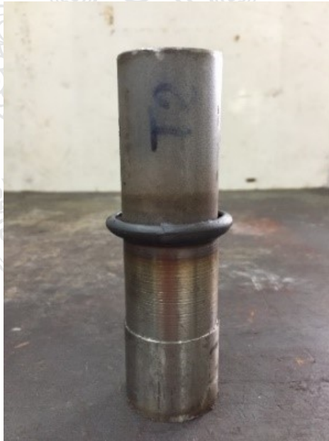
รูปที่ ข.2 ชิ้นงานที่ทำการเชื่อมด้วยแรงเสียดทานด้วยความเร็วรอบ 2,500 รอบ/นาที ความดันกด แซ่ 20 บาร์ ที่เวลา 10 วินาที ความดันที่กดอัด 25 บาร์ ที่เวลา 7 วินาที
