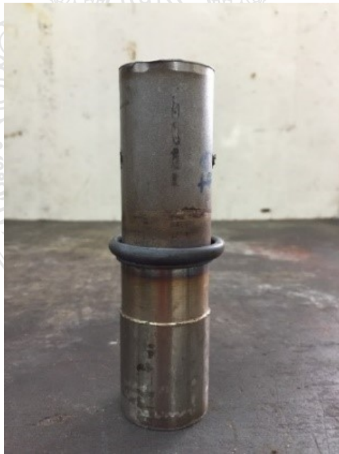
รูปที่ ข.4 ชิ้นงานที่ทำการเชื่อมด้วยแรงเสียดทานด้วยความเร็วรอบ 2,500 รอบ/นาที ความดันกด แซ่ 20 บาร์ ที่เวลา 10 วินาที และ ความดันที่กดอัด 30 บาร์ ที่เวลา 5 วินาที
