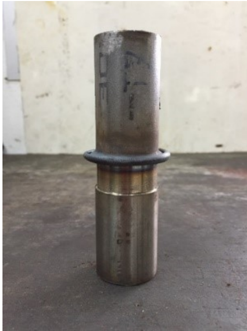
รูปที่ ข.7 ชิ้นงานที่ทำการเชื่อมด้วยแรงเสียดทานด้วยความเร็วรอบ 2,500 รอบ/นาที ความดันกด แซ่ 20 บาร์ ที่เวลา 10 วินาที และ ความดันที่กดอัด 35 บาร์ ที่เวลา 5 วินาที
