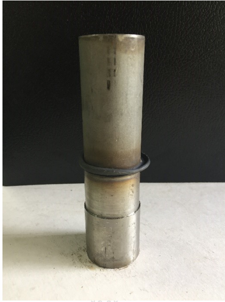
รูปที่ ก.5 ชิ้นงานที่ทำการเชื่อมด้วยแรงเสียดทานด้วยความเร็วรอบ 2,500 รอบ/นาที ความดันที่กด แซ่ 20 บาร์ กดแซ่ 10 วินาที ความดันที่กดอัด 20 บาร์และกดอัดเวลา 7 วินาที
