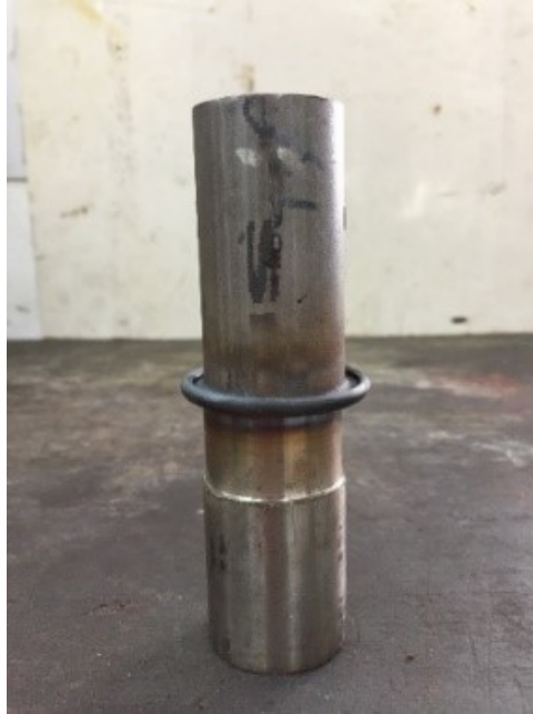
รูปที่ ข.3 ชิ้นงานที่ทำการเชื่อมด้วยแรงเสียดทานด้วยความเร็วรอบ 2,500 รอบ/นาที ความดันกด แซ่ 20 บาร์ ที่เวลา 10 วินาที ความดันที่กดอัด 25 บาร์ ที่เวลา 9 วินาที
