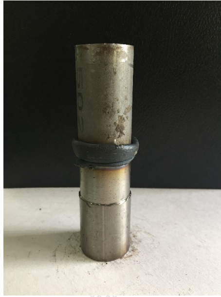
รูปที่ ก.13 ชิ้นงานที่ทำการเชื่อมด้วยแรงเสียดทานด้วยความเร็วรอบ 2,500 รอบ/นาที ความดันที่กดแช่ 20 บาร์ กดแช่ 10 วินาที ความดันที่กดอัด 40 บาร์และกดอัดเวลา 9 วินาที
