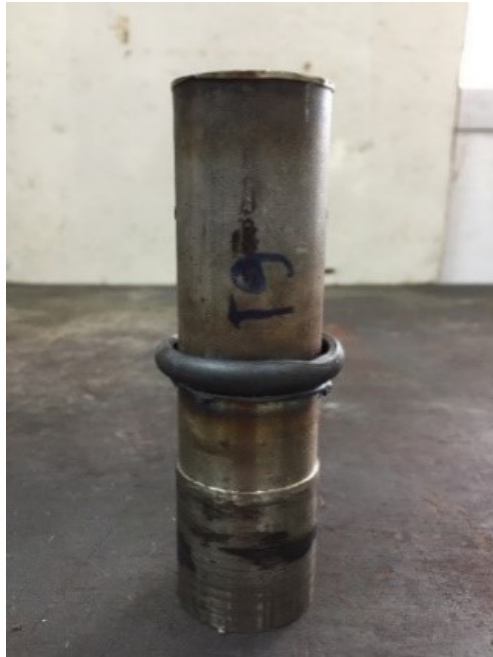
รูปที่ ข.9 ชิ้นงานที่ทำการเชื่อมด้วยแรงเสียดทานด้วยความเร็วรอบ 2,500 รอบ/นาที ความดันกด แฉะ 20 บาร์ ที่เวลา 10 วินาที และ ความดันที่กดอัด 35 บาร์ ที่เวลา 9 วินาที
