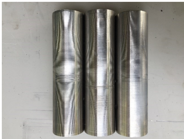
รูปที่ 3.9 ชิ้นงานที่ผ่านการกลึง และเพื่อทดสอบแรงดึง
