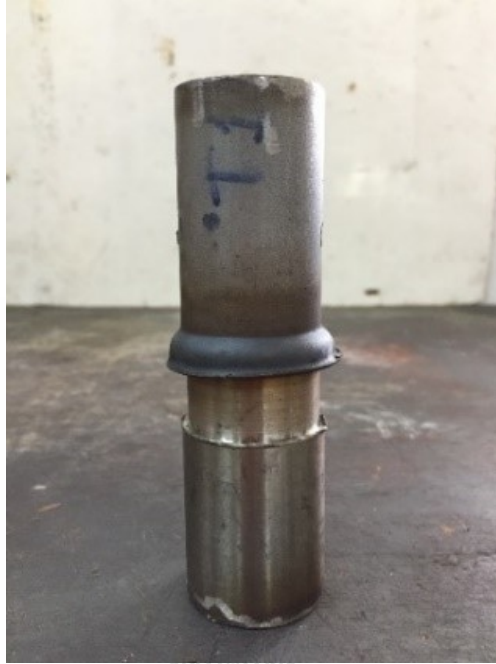
รูปที่ ข.1 ชิ้นงานที่ทำการเชื่อมด้วยแรงเสียดทานด้วยความเร็วรอบ 2,500 รอบ/นาที ความดันกด แซ่ 20 บาร์ ที่เวลา 10 วินาที และ ความดันที่กดอัด 25 บาร์ ที่เวลา 5 วินาที
