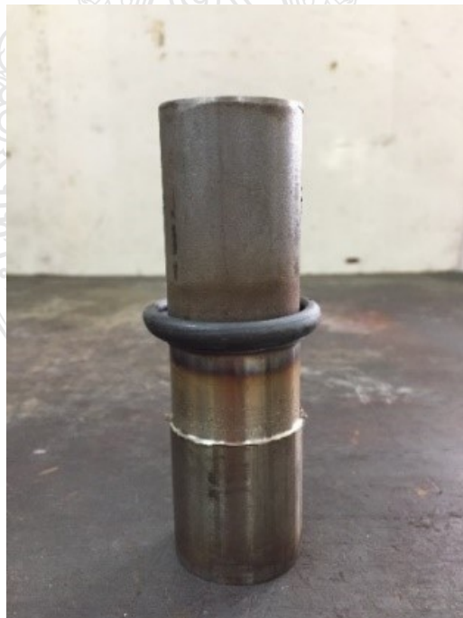
รูปที่ ข.6 ชิ้นงานที่ทำการเชื่อมด้วยแรงเสียดทานด้วยความเร็วรอบ 2,500 รอบ/นาที ความดันกด แช่ 20 บาร์ ที่เวลา 10 วินาที และ ความดันที่กดอัด 30 บาร์ ที่เวลา 9 วินาที
