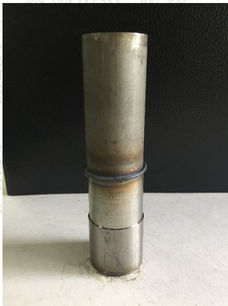
รูปที่ ก.2 ชิ้นงานที่ทำการเชื่อมด้วยแรงเสียดทานด้วยความเร็วรอบ 1,800 รอบ/นาที ความดันที่กด แซ่ 20 บาร์ ความดันที่กดอัด 20 บาร์และกดอัดเวลา 3 วินาที
