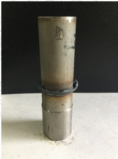
รูปที่ ก.6 ชิ้นงานที่ทำการเชื่อมด้วยแรงเสียดทานด้วยความเร็วรอบ 2,500 รอบ/นาที ความดันที่กด แซ่ 20 บาร์ กดแซ่ 10 วินาที ความดันที่กดอัด 20 บาร์และกดอัดเวลา 9 วินาที
