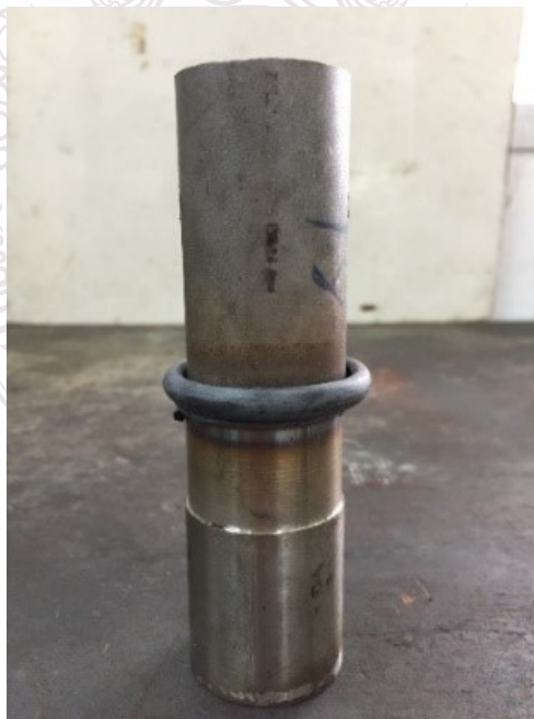
รูปที่ ข.8 ชิ้นงานที่ทำการเชื่อมด้วยแรงเสียดทานด้วยความเร็วรอบ 2,500 รอบ/นาที ความดันกด แซ่ 20 บาร์ ที่เวลา 10 วินาที และ ความดันที่กดอัด 35 บาร์ ที่เวลา 7 วินาที
