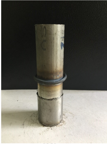
รูปที่ ก.9 ชิ้นงานที่ทำการเชื่อมด้วยแรงเสียดทานด้วยความเร็วรอบ 2,500 รอบ/นาที ความดันที่กด แช่ 20 บาร์ กดแช่ 10 วินาที ความดันที่กดอัด 20 บาร์และกดอัดเวลา 7 วินาที
