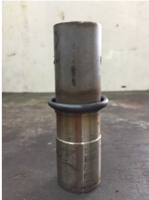
รูปที่ ข.5 ชิ้นงานที่ทำการเชื่อมด้วยแรงเสียดทานด้วยความเร็วรอบ 2,500 รอบ/นาที ความดันกด แช่ 20 บาร์ ที่เวลา 10 วินาที และ ความดันที่กดอัด 30 บาร์ ที่เวลา 7 วินาที
