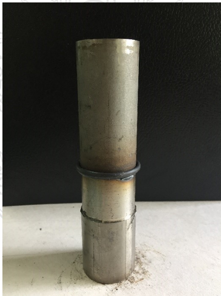
รูปที่ ก.8 ชิ้นงานที่ทำการเชื่อมด้วยแรงเสียดทานด้วยความเร็วรอบ 2,500 รอบ/นาที ความดันที่กด แช่ 20 บาร์ กดแช่ 10 วินาที ความดันที่กดอัด 20 บาร์และกดอัดเวลา 5 วินาที
