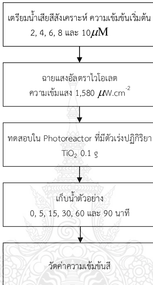
รูปที่ 3.1 ขั้นตอนการหาประสิทธิภาพการบำบัดสีในน้ำเสียสังเคราะห์ด้วยกระบวนการโฟโตคะตะลิติก
