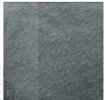
ค) ผ้าขึ้นขนซักด้วยสารซักฟอก พีเอช 11.26 ผสม เอนไซม์(ขึ้นขนระดับ 4)
