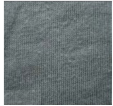
ค) ผ้าขึ้นขนซักด้วยสารซักฟอก พีเอช 8.85 ผสมเอนไซม์ (ขึ้นขนระดับ 5)
