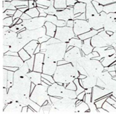
รูปที่ 2.4 โครงสร้างจุลภาคเหล็กกล้าไร้สนิมกลุ่มออสเทนนิติก AISI304 [23]
