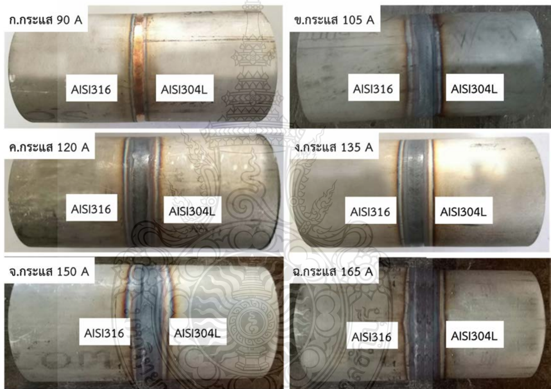
รูปที่ 4.1 อิทธิพลของกระแสเชื่อมอาร์คทั้งสแตนเลสคลุมแบบไม่เติมลวดเชื่อมที่มีผลต่อผิวหน้าของโลหะเชื่อมท่อนเหล็กกล้าไร้สนิมต่างชนิด AISI316 และ AISI304L
