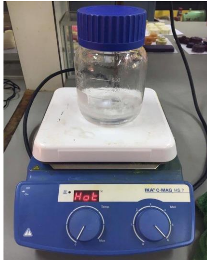
รูปที่ ข.3 การเตรียมตัวเร่งปฏิกิริยาโซเดียมไฮดรอกไซด์และเมทานอล
