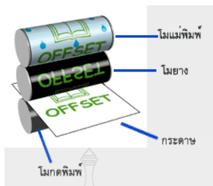
ภาพที่ 2.1 แสดงโมทั้ง 3 ในระบบการพิมพ์ออฟเซต
