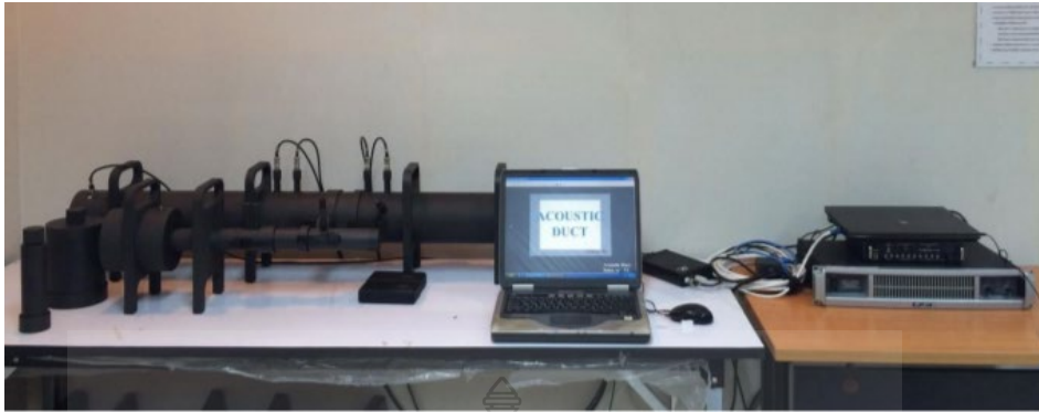
รูปที่ 3.24 เครื่องการทดสอบหาความสามารถในการกั้นเสียงโดยเครื่อง Impedance tube
