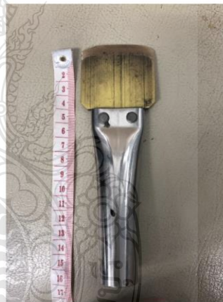
รูปที่ 3 มีดสำหรับการยืนกรีดยางบนเครื่องบดยางสองลูกกลิ้ง ระบบเปิด
