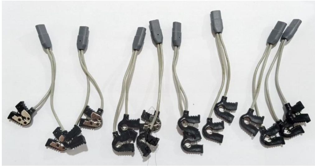
รูปที่ ข.3 สายวัดสัญญาณติดเข้ากับแผ่นอิเล็กโทรดสำหรับติดบนผิวหนัง
