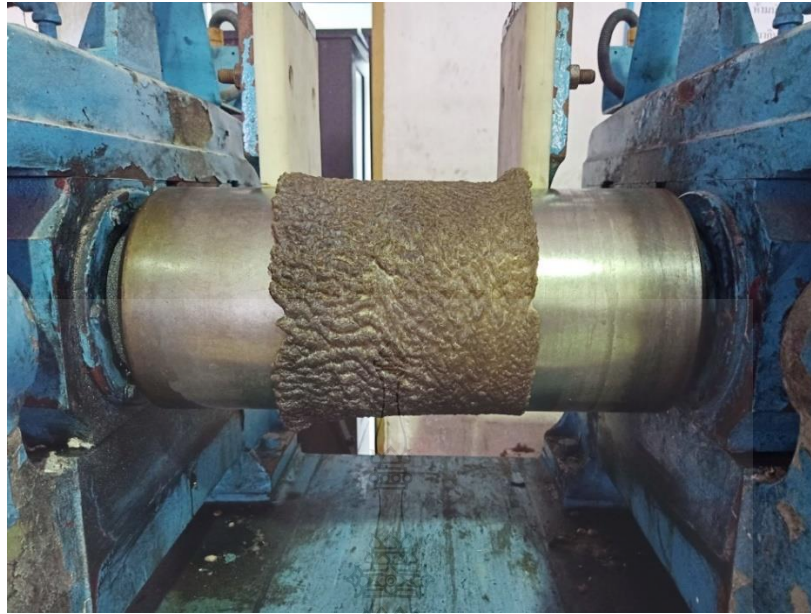
รูปที่ ข.7 ลักษณะการพันรอบลูกกลิ้งของยาง STR 20 บนเครื่องผสมยางสองลูกกลิ้งระบบเปิด (Open System Rubber Two-Roll Mill Mixer Machine)
