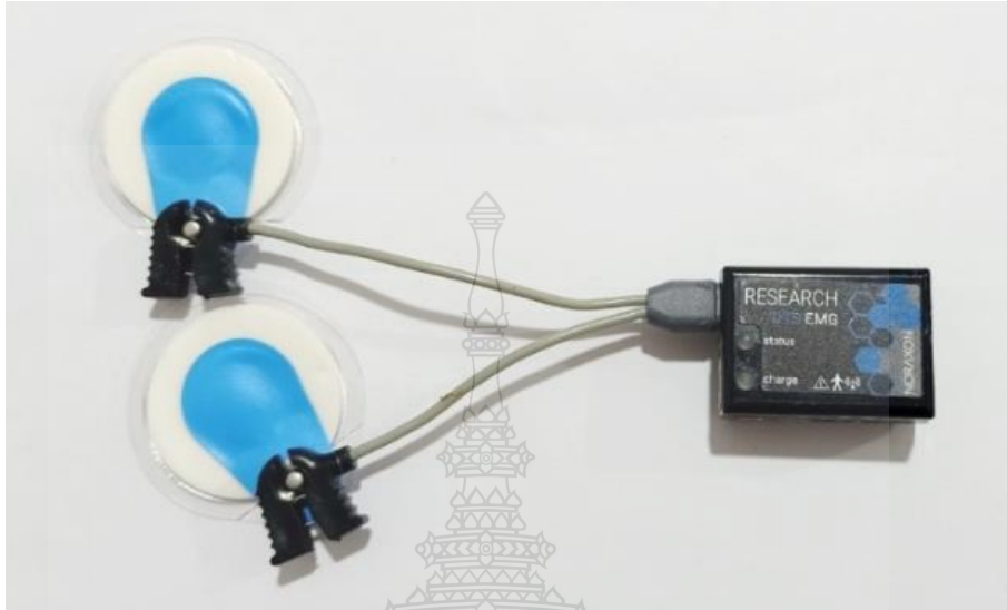
รูปที่ ข.1 เซนเซอร์วัดสัญญาณกล้ามเนื้อ และเครื่องส่งสัญญาณ Model 548 DTS EMG Sensors
