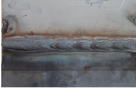
รูปที่ ข.4 แสดงชิ้นงานเชื่อม กระแสไฟฟ้าในการเชื่อม 180 แอมป์ ความเร็วในการเชื่อม 200มิลลิเมตร/นาที่
