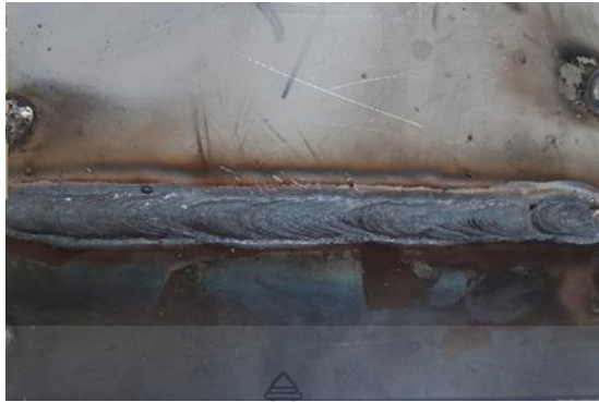
รูปที่ ข.7 แสดงชิ้นงานเชื่อม กระแสไฟฟ้าในการเชื่อม 200 แอมป์ ความเร็วในการเชื่อม 200 มิลลิเมตร/นาที
