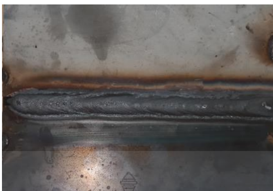
รูปที่ ข.13 แสดงชิ้นงานเชื่อมกระแสไฟฟ้าในการเชื่อม 180 แอมป์ความเร็วในการเชื่อม 200 มิลลิเมตร/นาที
