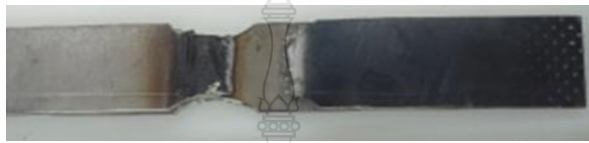
รูปที่ ค.13 แสดงการขาดของชิ้นงานเชื่อมกระแสไฟฟ้าในการเชื่อม 180 แอมแปร์ ความเร็วในการเชื่อม 200 มิลลิเมตรต่อนาที
