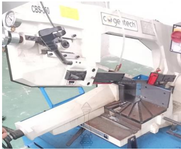
รูปที่ จ.7 แสดงรูปตัดชิ้นงานเพื่อขึ้นรูปในการทดสอบแรงดึงและศึกษาโครงสร้างจุลภาค
