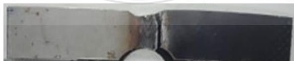
รูปที่ ค.18 แสดงการขาดของชิ้นงานเชื่อมกระแสไฟฟ้าในการเชื่อม 200 แอมแปร์ ความเร็วในการเชื่อม 300 มิลลิเมตรต่อนาที
