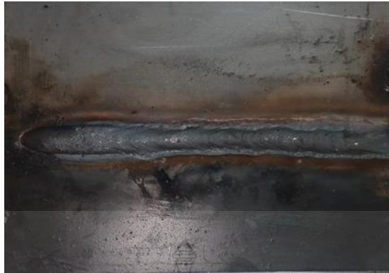
รูปที่ ข.10 แสดงชิ้นงานเชื่อมกระแสไฟฟ้าในการเชื่อม 160 แอมป์ความเร็วในการเชื่อม 200 มิลลิเมตร/นาที
