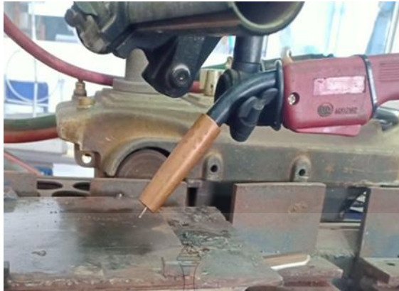
รูปที่ จ.4 แสดงรูปการติดตั้งชิ้นงานกับอุปกรณ์จับยึดเพื่อใช้กระยะแนวเดินเชื่อม
