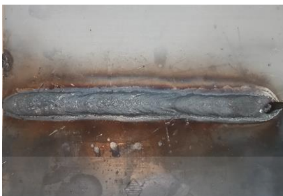
รูปที่ ข.16 แสดงชิ้นงานเชื่อมกระแสไฟฟ้าในการเชื่อม 200 แอมป์ความเร็วในการเชื่อม 200 มิลลิเมตร/นาที
