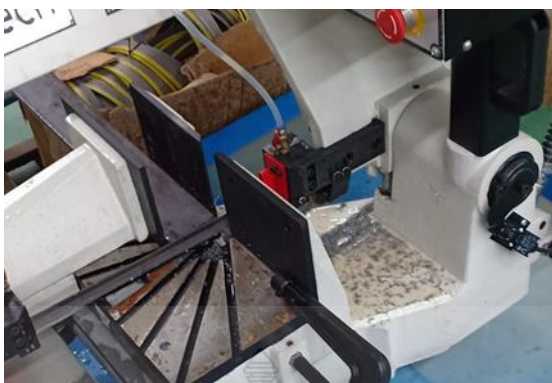
รูปที่ จ.1 แสดงรูปการตัดแผ่นเหล็กกล้าคาร์บอน SS400
