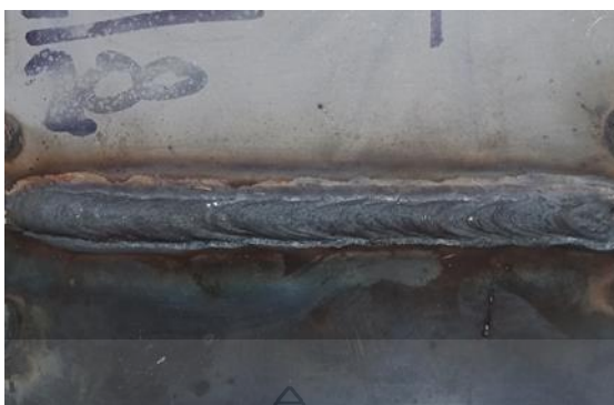
รูปที่ ข.1 แสดงชิ้นงานเชื่อม กระแสไฟฟ้าในการเชื่อม 160 แอมป์ ความเร็วในการเชื่อม 200 มิลลิเมตร/นาที
