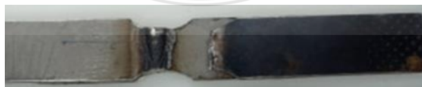
รูปที่ ค.15 แสดงการขาดของชิ้นงานเชื่อมกระแสไฟฟ้าในการเชื่อม 180 แอมแปร์ ความเร็วในการเชื่อม 300 มิลลิเมตรต่อนาที
